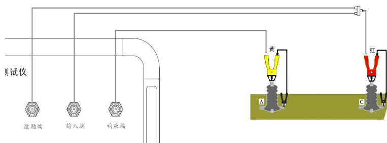
图 2 频响法测试接线图
